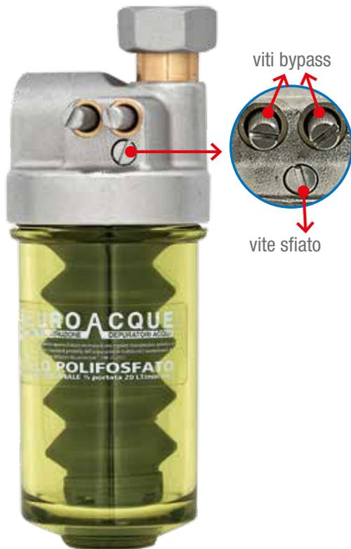
**DESCRIZIONE.** Dosatore con attacchi a squadra, codolo collegamento, valvola di sfiato, by-pass e regolatore consumo. Permette installazioni in spazi limitati come la dima delle caldaie murali.
