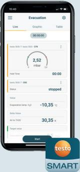
La testo Smart App ti guida in modo rapido e semplice attraverso le misure su impianti di refrigerazione, climatizzazione e riscaldamento.
