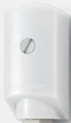
**Descrizione tecnica:** Relè crepuscolare - Montaggio a palo e a parete, singola uscita - 1 NO 12 A, 12 A, Tipo di alimentazione AC, tensione di alimentazione nominale 230 V, funzionamento da 0.8 a 1.1 V, potenza nominale 1.5 VA, temperatura ambiente da -30 a +70 °C
